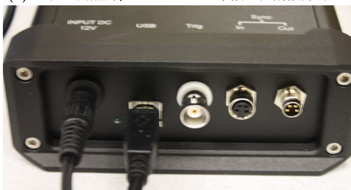
(b) 主机背面照片。5个接口自左至右分别是电源插口、USB插口、触发口、同步时钟入口、同步时钟出口
