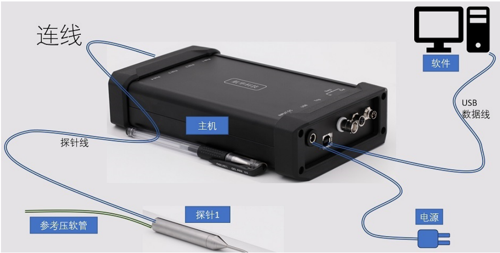
图 4: 系统连接方法示意图
