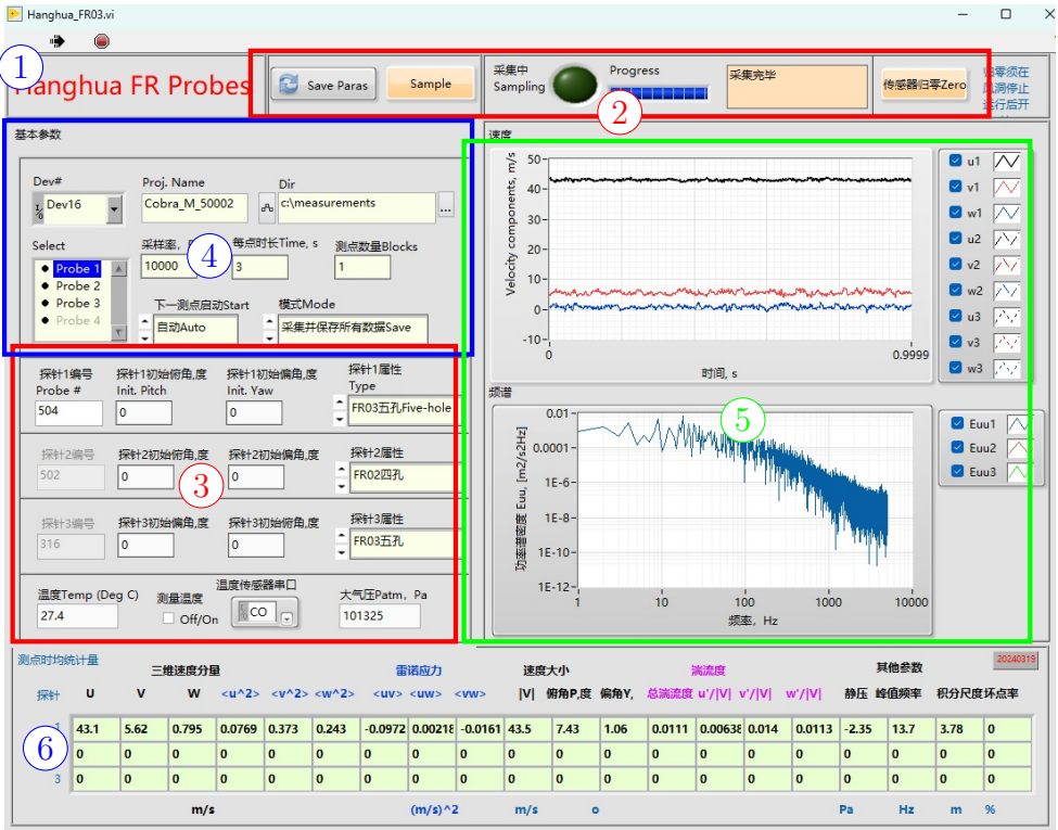
图 6: 软件主界面分为不同的功能区：①程序控制、②采集操作、③探针编号及初始角、④采集设置、⑤数据及能谱实时显示、⑥统计量显示。
