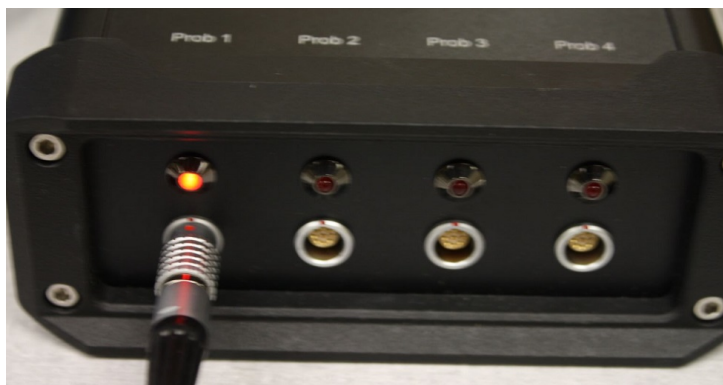
(a) 主机正面照片，Probe1-3 三个接口分别接探针1-3
