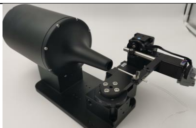
图 3 一个安放在航华 CR04 标定器上的 HW1A 热线探头
