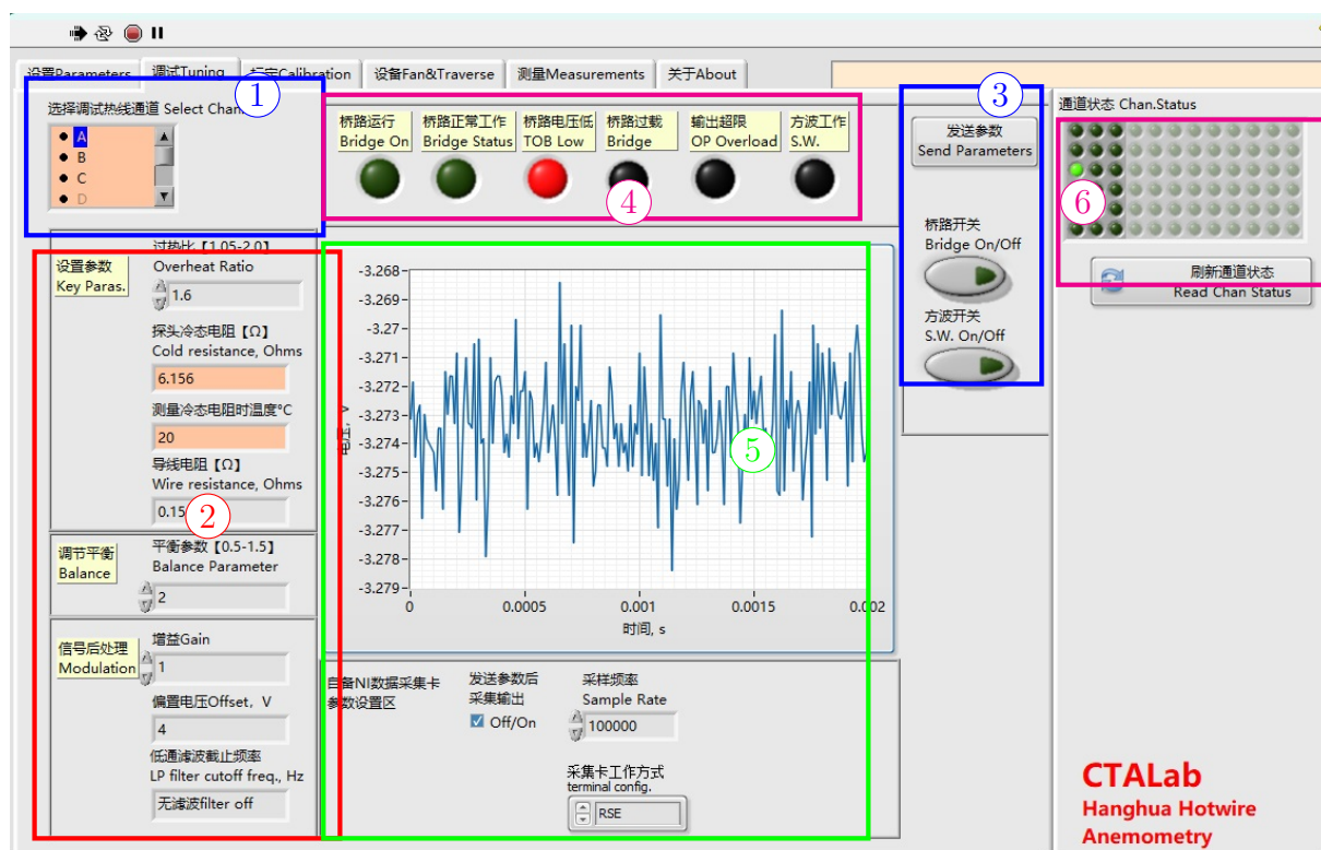
图 16: 调试选项卡分为不同的功能区：① 选择通道、②设置通道工作参数、③发送参数、开关电桥及方波测试、④ 当前通道状态指示灯、⑤ 当前通道电压输出波形图、⑥ 全部通道状态指示灯。
