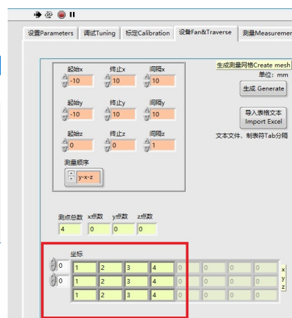
图 J.1: 使用Excel创建移测架坐标文件并导入CTALab
