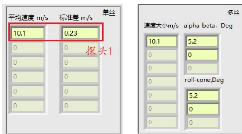
(a) 单丝热线探头测量结果的统计量 (b) 双丝和多丝探头结果的统计量
