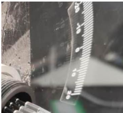
图 15 安装模型后，可通过角度尺读取尾缘的角度，以此作为翼型迎角
