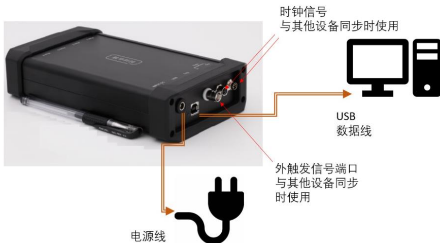
图 12 电子压力扫描阀的电源与数据线连接方法示意图
