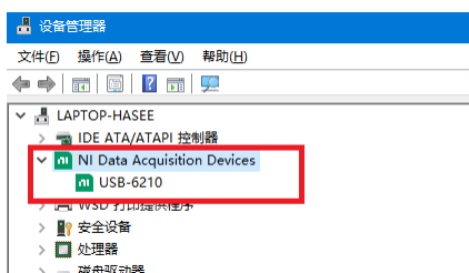
图 11 正确安装 DAQmx 驱动后, DAQ16 数采仪设备显示在设备管理器中
