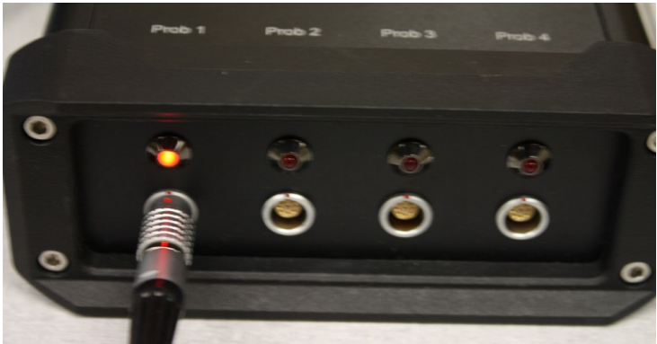
(a) 主机正面照片，四个接口分别接探针1-4
