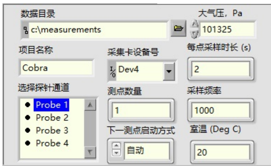
图 12: 软件功能区④：采集参数设置
