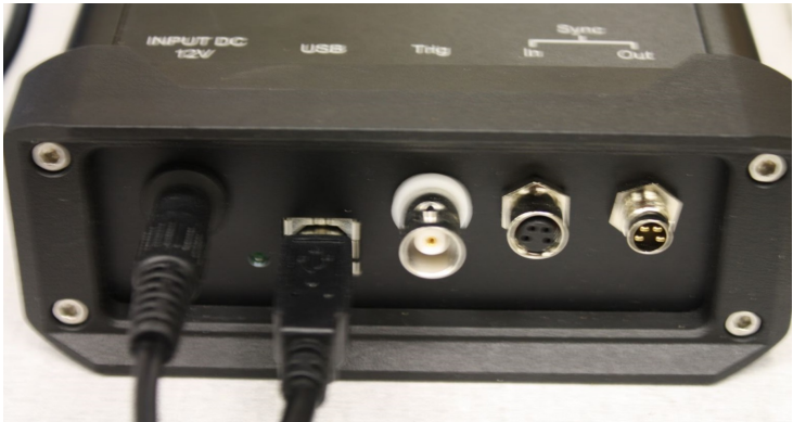
(b) 主机背面照片。5个接口自左至右分别是电源插口、USB插口、触发口、同步时钟入口、同步时钟出口
