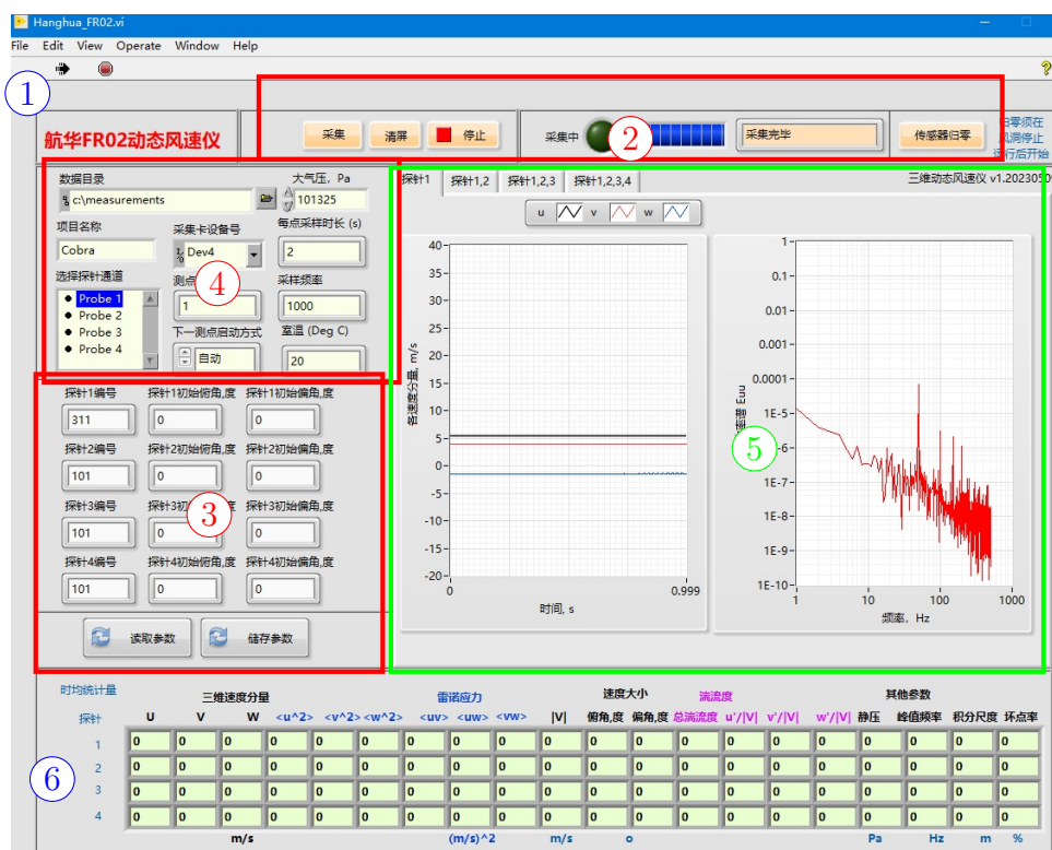
图 7: 软件主界面分为不同的功能区: ①程序控制、②采集操作、③探针编号及初始角、④采集设置、⑤数据及能谱实时显示、⑥统计量显示。
