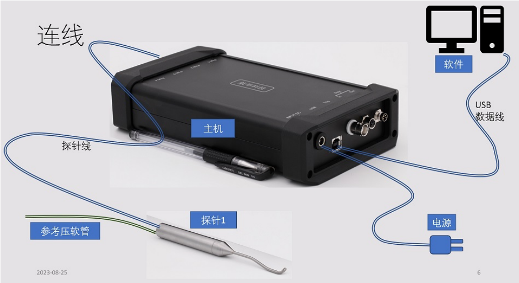
图 5：系统连接方法示意图
