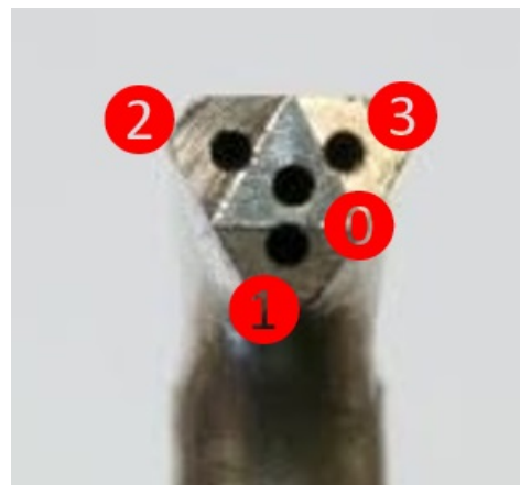
(b) 探针头部照片及测压孔编号
