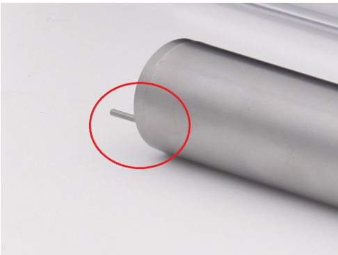
(b) 探针的参考压连接端口
